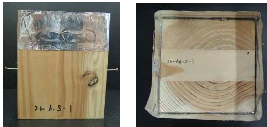
図1 被覆後の試験片(左側:側面の写真、右側:上面の写真)
