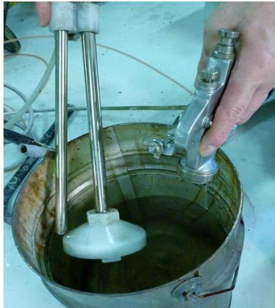
洗浄が完了したらリターンバルブを閉め、②ダイヤフラムの塗料吸い込みホースを抜きG-CATガンからホースに残っている洗浄シンナーを抜く
