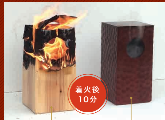
一般木材/2液型ウレタン塗装 不燃木材に着色しファイヤーブレイクF4を塗装
