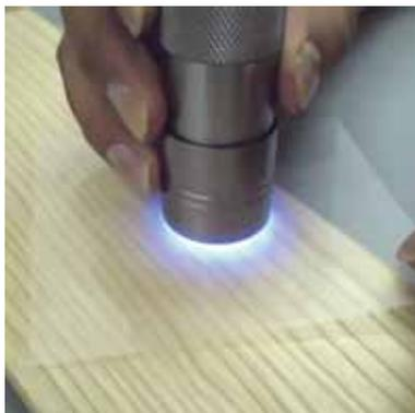
**2** 数秒～数十秒専用 LED ランプの光をあてて硬化させます。PET、ポリプロピレン等のシートをかぶせて光を当てることでより硬化性が向上します。(空气中の酸素を遮断する)
