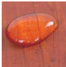
キセノンウエザオメーター 150 時間後の撥水性試験
